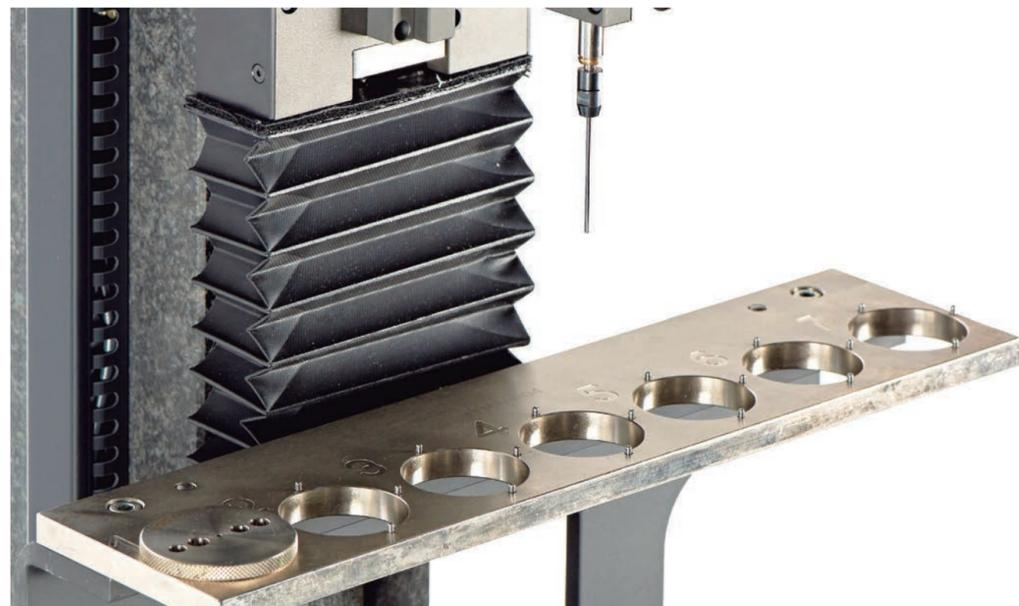
El diseño tecnológico del robot de calibración EDR 700 permite un ajuste preciso de manera automática de cualquier inyector Common Rail BOSCH, VDO, DENSO y CAT.
