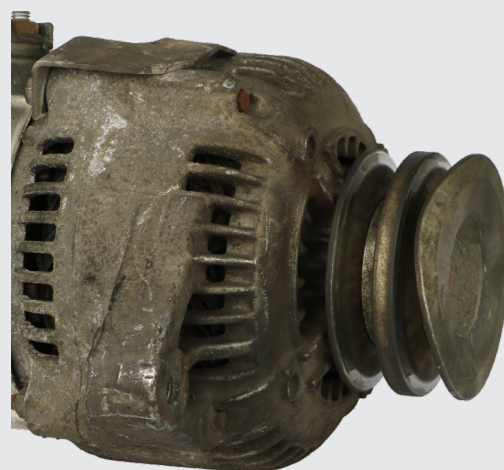
Polea dañada o en falta
