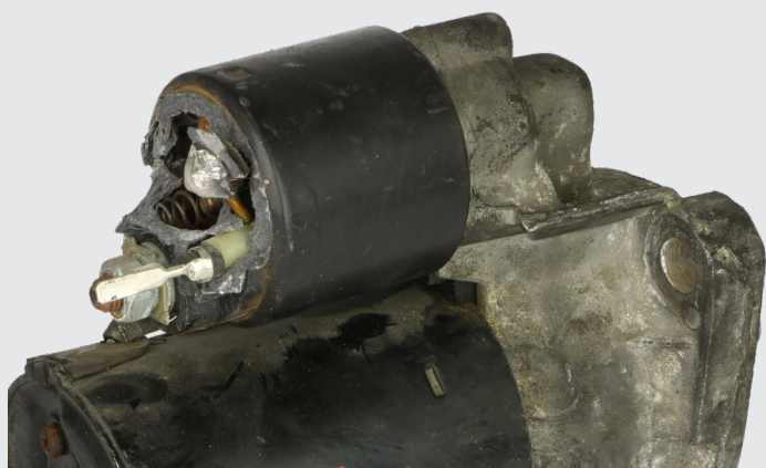
Solenóide ou ficha/ conector danificado
