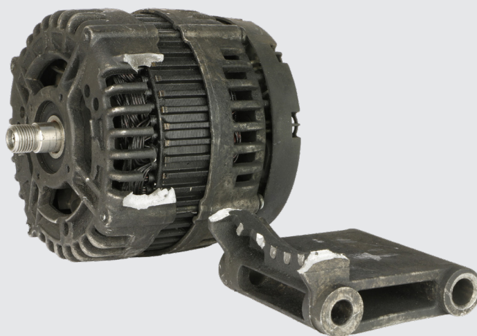
Beschädigte(s) Gehäuse, Halterung oder Befestigung
